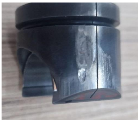
Рисунок 7.6 – Поршень гидромотора с эксплуатационным повреждением
