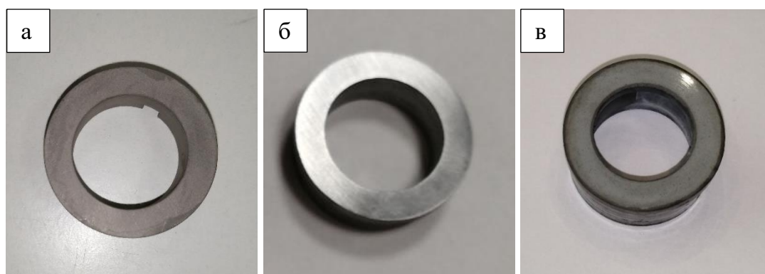
Рисунок 2.8 – Внешний вид образцов для испытания на трение: а) Ni-SiC после осаждения; б) сплав АК7ч; в) контртело из стали 45 с покрытием \text{Al}_2\text{O}_3 + \text{Cr}_2\text{O}_3
