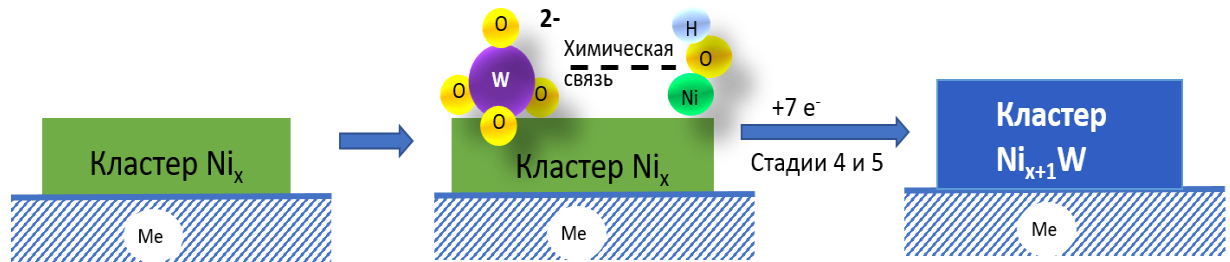
Рисунок 3.4 – Схема роста кластеров в покрытии Ni-W
