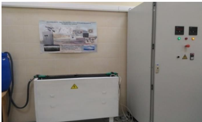
Рисунок 2.3 – Общий вид установки ИПТ-1000 для проведения МДО
